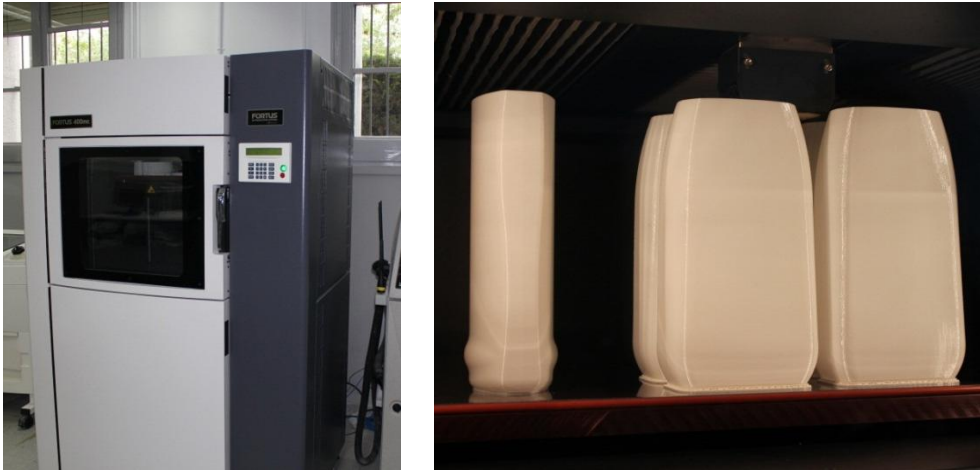
Fig. 3. Sistema de fabricación Fortus 400mc, de Stratasys (izquierda) y fabricación de prototipos en Policarbonato (derecha).
