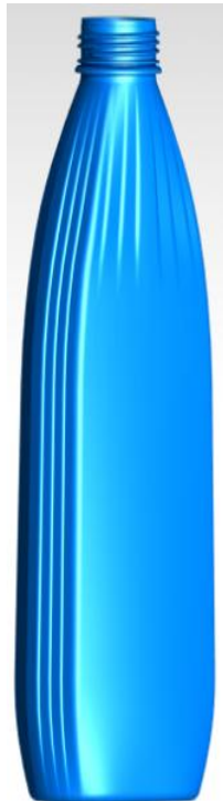
Fig. 4 Diseño final con rigidizadores estructurales (DS).
