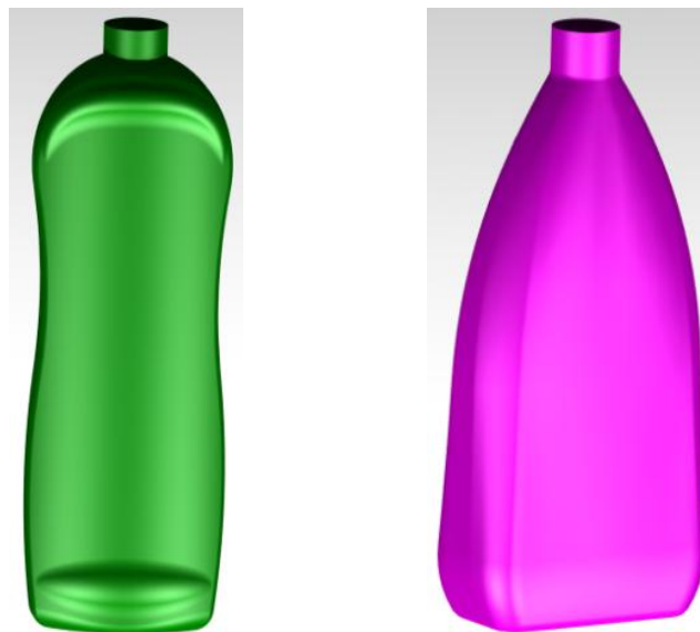
Fig. 2. Modelos CAD del envase de referencia (izquierda) y del nuevo diseño (derecha).
