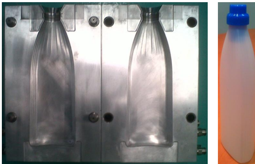
Fig. 6. Molde piloto y uno de los envases fabricados en él.
